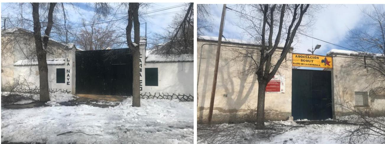
Todas las edificaciones existentes son de una sola altura y consisten en una nave de planta rectangular de proporción longitudinal, formada por una única cruja con cerchas apoyadas en los muros laterales exteriores. La nave se divide en varios recintos mediante muros transversales.
